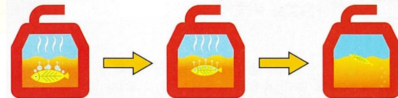
روش آگیری، خشک کردن و پخت در فشار پایین و حرارت دهی غیرمستقیم روغن
